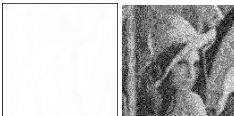
Rys. 38. Różnica obrazów po filtracji w programie MATLAB i po filtracji sprzętowej. Od lewej: obraz w skali 0-255 (dodano obwiednie w celu wyznaczenia granic obrazu), obraz przeskalowany.
