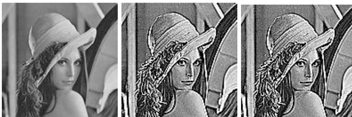
Rys. 39. Wynik filtracji wyostrajającej (ang. high boost ). Od lewej: obraz źródłowy, po filtracji w programie MATLAB, po filtracji sprzętowej.
