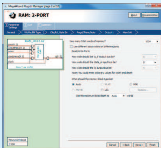
Rysunek 12. Ustawienie wielkości pamięci na 1024 słowa oraz szerokości słowa na 9 bitów
